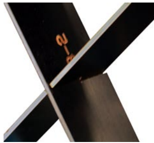
Bild 4.3-2 Realisierte Variante und Prototyp der Steckverbindung
