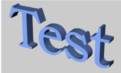
Zum 3D-Objekt gewandeltes Spline mit automatisch erzeugten Löchern
