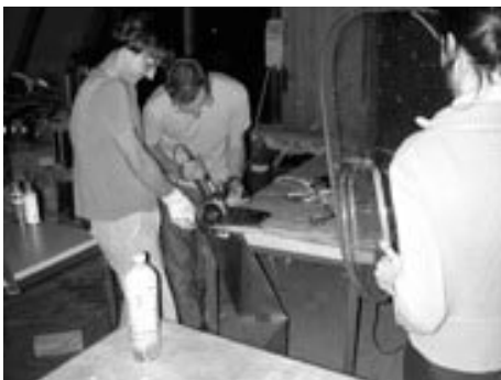
Nachbearbeitung: Bei einigen Einzelelementen mussten nach dem Lasern punktuelle Verunreinigungen und Grate entfernt werden. Durch eine Biegemaschine wird den Elementen kaltgeformt und erhalten ihre finale Geometrie. In den Einzelobjekten ist ein Code eingelasert, der ihnen jeweils spezifische Biegeradien zuordnet.
