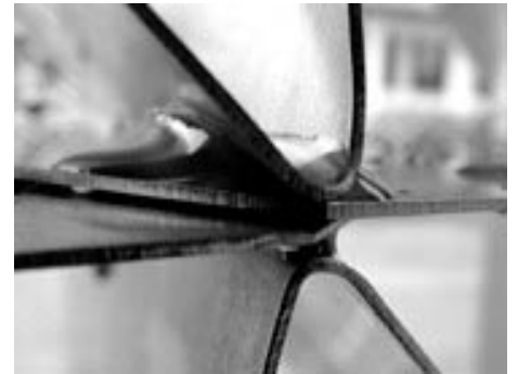
Details: Das hochflexible Knotenpunktsystem von S X M durchläuft zur Zeit seine praktische Testphase unter freiem Himmel. Seit drei Monaten hält es Wind-, Witterungs- und Schneelasten stand.
