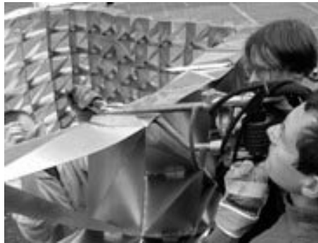
Aufbau: Der Zusammenbau erfolgt sequentiell nach einem vorgegebenen Muster. Element rastet in Element. Ring folgt auf Ring und wird mit Edelstahlnieten zusammengefügt. Das Gesamtprojekt wird in zwei Segmenten erstellt, die als ganzes zusammengefügt werden.
