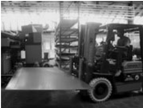
Anlieferung: Das Rohmaterial wird über den Stahl-grosshandel bezogen. Die Lieferung erfolgt termingerecht in grossen Chargen. Durch die Beschränkung auf einen Materialtyp und eine Blechdicke ist eine grosszügige Lagerhaltung möglich.
